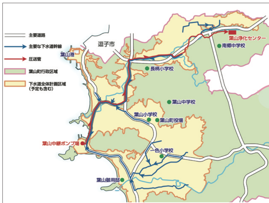
海沿いの中継ポンプ場と山側の浄化センターが4.7キロもの圧送管でつながっている。上は「うんこドリル 下水道」より。
